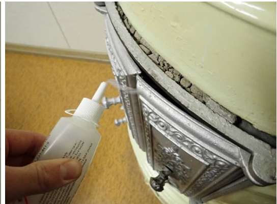
Kuva 40. Vanhoissa hormoneissa olevissa venttiileissä ja tulisijoissa todettiin olevan poistoilmavirtaus merkkisavun avulla.
