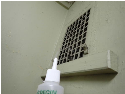
Kuva 40. Vanhoissa hormoneissa olevissa venttiileissä ja tulisijoissa todettiin olevan poistoilmavirtaus merkkisavun avulla.
