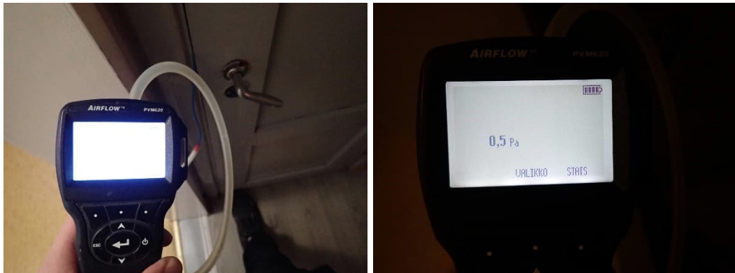
Kuva 37. Hetkellinen paine-ero toisesta kerroksesta yläpohjatilaan oli noin 0,5 Pa.
